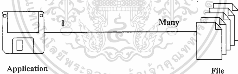
รูปที่ 8 แสดงความสัมพันธ์แบบ One-to-Many ระหว่าง Application กับ File
