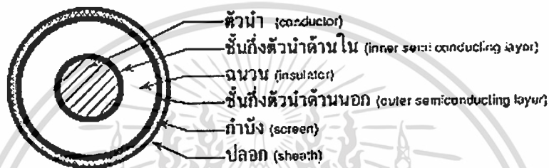
รูปที่ 2.6 แสดงภาคตัดขวางของสายเคเบิลชนิดฉนวน โพลิเมอร์
