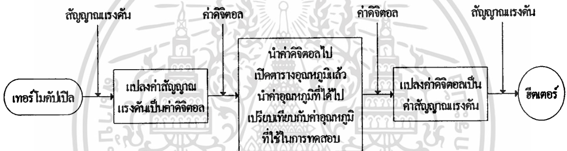
รูปที่ 3.3 แสดงไดอะแกรมการทำงานของโปรแกรมย่อยการควบคุมอุณหภูมิ
