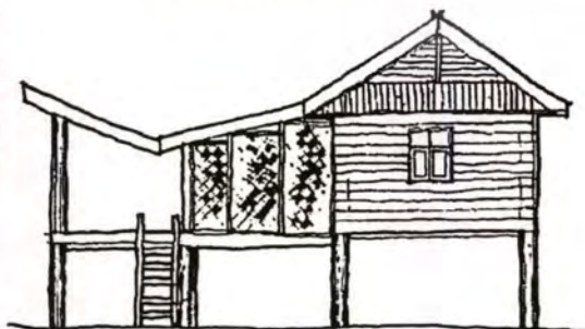
ภาพที่ 2.17 แสดงลายเส้นที่ 2.10 บางครั้งจะมีการต่อเพิงออกไปจาก เรือนเกย อาจใช้หลังคาลาดไปทางเดียวกันหรือเป็นเพิงหมา
