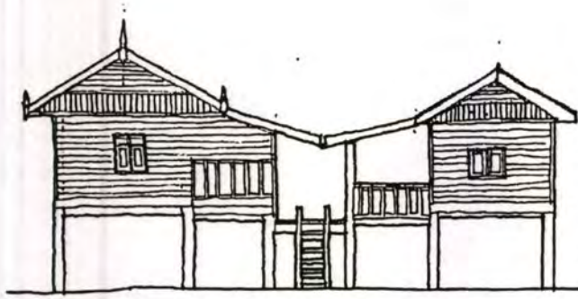
ภาพที่ 2.18 แสดงลายเส้นที่ 2.11 เรือนเกยอาจพบต่อกัน 2 เรือน และส่วนเกยอาจมีการกันผนังถาวรเปิดช่อง หน้าต่าง ในกรณีนี้ส่วนเกย ของเรือนซ้ายมือทำ เป็นฝาไหล
