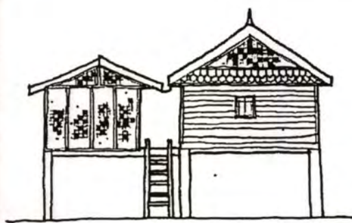
ภาพที่ 2.23 แสดงลายเส้นที่ 2.14 เรือนแปล จะเป็นเรือน 2 เรือนติดกัน โดยคานของเรือนที่มาฝากจะใช้เสาของเรือนใหญ่ ขนาดของเรือนที่มาฝากอาจจะเล็กกว่าหรือเท่ากันก็ได้
