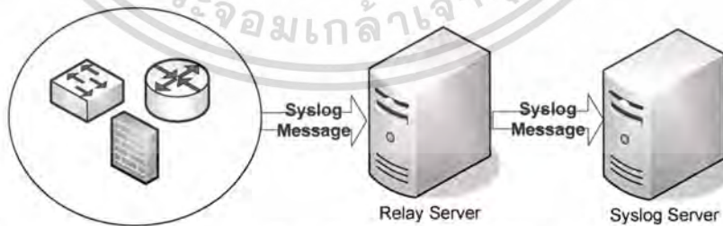
รูปที่ 2.2 syslog server เชื่อมต่อถึงกัน โดยผ่านตัวกลางที่เรียกว่ารีเลย์เซิร์ฟเวอร์
