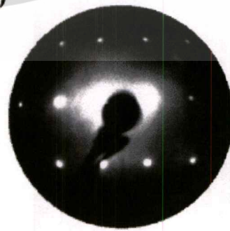
รูปที่ 2.22 LEED pattern ของพื้นผิว Cu(110) ที่พลังงานของลำอิเล็กตรอน 90 eV และ 140 eV เอกสารนี้เป็นเอกสารที่สงวนไว้สำหรับการใช้งานเพื่อการศึกษาเท่านั้น ไม่อนุญาตให้นำไปใช้ประโยชน์ด้านการค้า ไม่ว่าจะกรณีใดๆทั้งสิ้น อีกทั้งห้ามมิให้ดัดแปลงเนื้อหา และต้องอ้างอิงถึงเจ้าของเอกสารทุกครั้งที่มีการนำไปใช้
