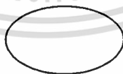
รูปที่ 2.6 สัญลักษณ์แสดงแอตทริบิวต์ (Attribute)
