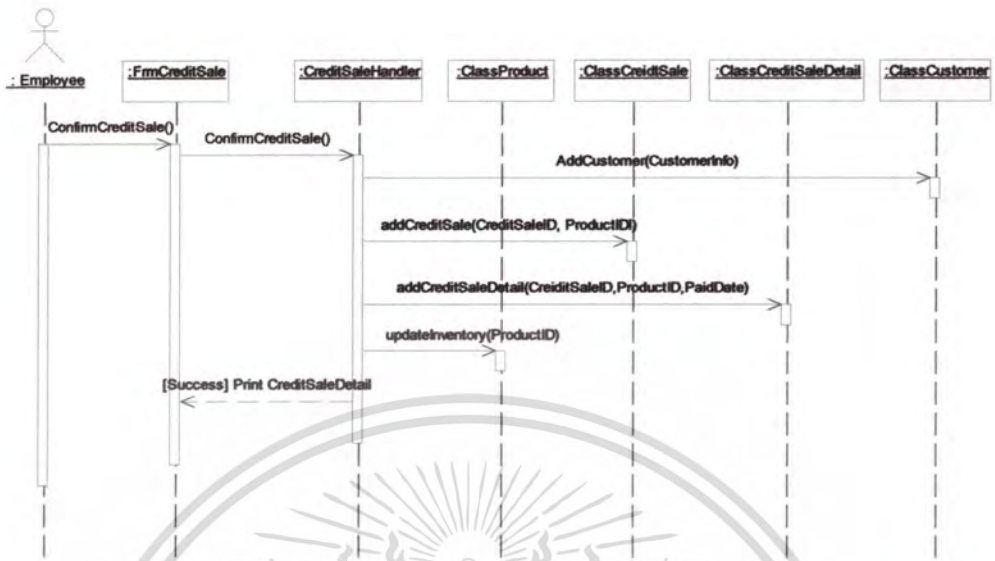
รูปที่ 4.16 Sequence Diagram ของ CreditSale หลังยื่นขึ้นชั้นการชำระเงิน (กรณีลูกค้าใหม่)
