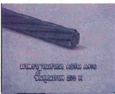
ภาพที่ ๓.25 ลวดแรงดึงสูง
