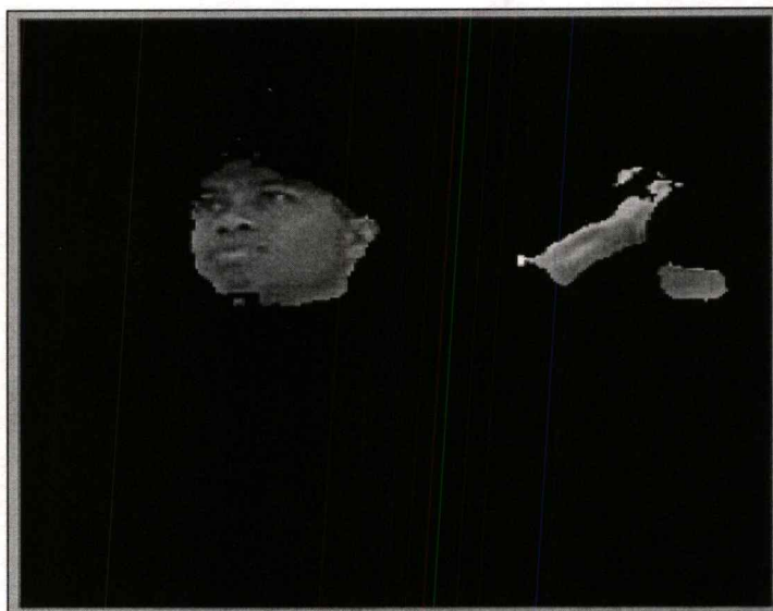
รูปที่ 2.3 ภาพ RGB format หลังจากทำ Skin detection
