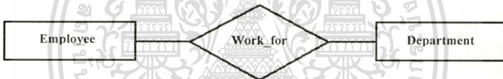
รูปที่ 2.6 แสดงความสัมพันธ์ชื่อ "สังกัดอยู่" ระหว่างเอนทิตีพนักงานกับเอนทิตีแผนก
