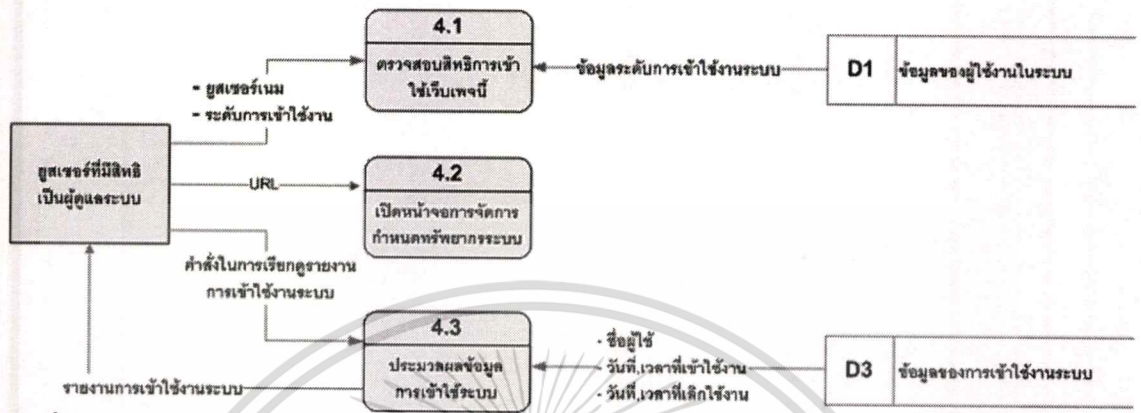
รูปที่ 3.16 แสดงแผนภาพการไหลของข้อมูลในระดับที่ 2 ของโปรเซสรายงานการเข้าใช้งานของระบบ
