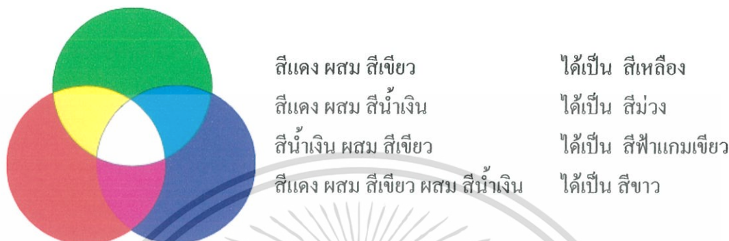
รูปที่ 3.3 แบบจำลองสี อาร์จีบี (RGB)
