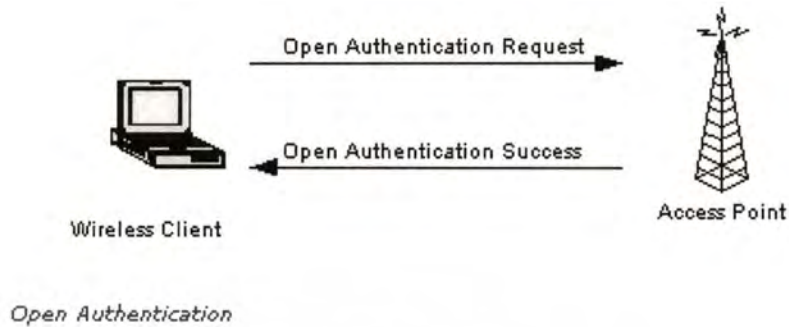
รูปที่ 2.3 แสดงระบบเปิด (Open System Authentication)
