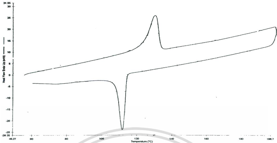
รูปที่ 4.15 กราฟตัวอย่างแสดงผลการวิเคราะห์สมบัติทางความร้อนด้วยเครื่อง DSC ของ HDPE
