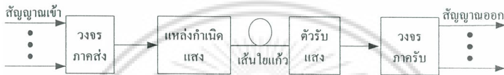
รูปที่ 3.3 แสดงระบบการสื่อสารด้วยเส้นใยแก้วนำแสง
