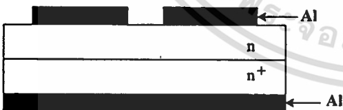
รูปที่ 4.2 ภาพภาคตัดขวางของกระบวนการสร้างตัวตรวจวัดแสง โครงสร้าง Al/n-Si/Al
