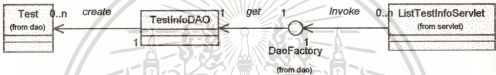
รูปที่ 4.39 คลาสไดอะแกรมแสดงคลาสที่เกี่ยวข้องกับการค้นรายการข้อมูลการทดสอบ
