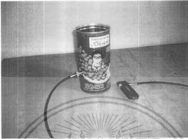
รูปที่ ก.5 การเชื่อมต่อระหว่าง USB Wireless LAN กับสายอากาศกระป๋อง
