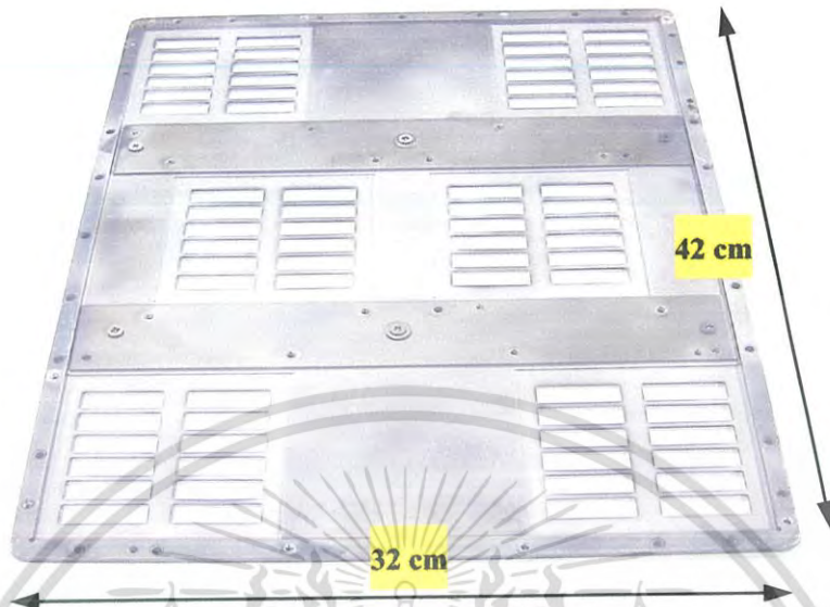
รูปที่ 5.2 ภาพถ่าย mask สำหรับใช้เคลือบ ITO ซึ่งเป็นชั้นขั้วไฟฟ้าโปร่งใส (TCO) บนสุดของเซลล์แสงอาทิตย์
