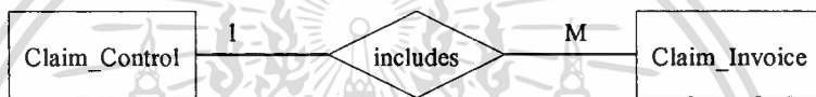
รูปที่ 4.4 ความสัมพันธ์ระหว่างคำขอชดเชยกับใบสั่งซื้อ
