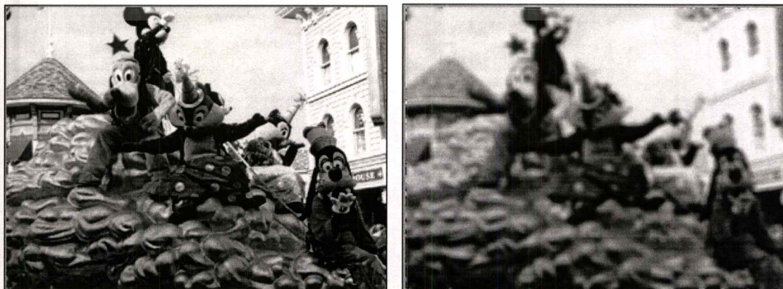
ภาพที่ 2.11 แสดงภาพตัวอย่างก่อนและหลังจากนำมาผ่าน Mean Filter ด้วย Mask 5x5
