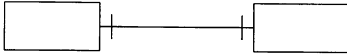
รูปที่ 2.15 สัญลักษณ์แทนความสัมพันธ์แบบหนึ่งต่อหนึ่ง
