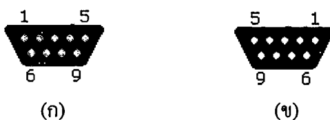
รูปที่ 2.1 หัวต่อแบบ 9 ขา(ก)ตัวผู้อยู่ทางด้านเครื่องคอมพิวเตอร์ (ข)ตัวเมียอยู่ทางด้านสาย
