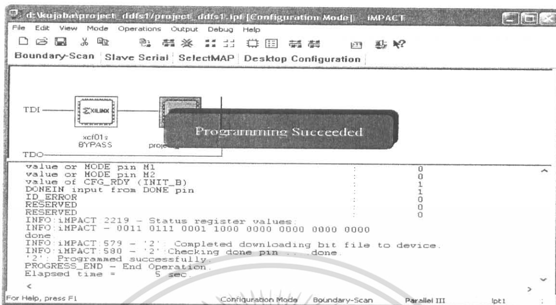
รูปที่ 4.44 แสดงการโปรแกรมวงจรลง FPGA และพร้อมใช้งาน
