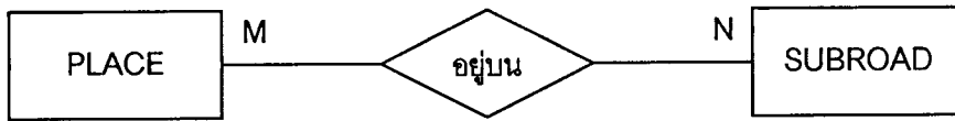
รูปที่ 4.3 ความสัมพันธ์ระหว่างเอนทิตีไต่ PLACE และ เอนทิตีไต่ SUBROAD
