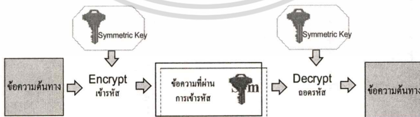
รูปที่ 2.2 แสดงการเข้ารหัสข้อความแบบ Symmetric Key
