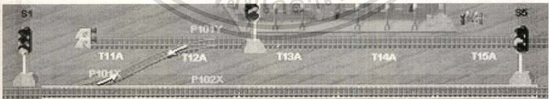
รูปที่ 4.34 S1 เป็น Start Signal แสดงไฟสีเขียวเมื่อ S5 ซึ่งเป็น End Signal แสดงไฟสีเขียว
