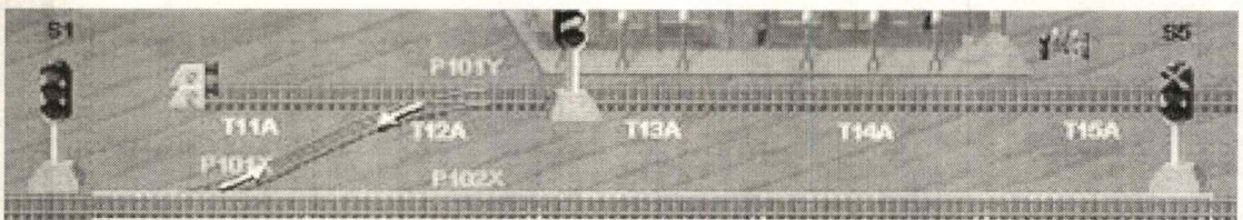
รูปที่ 4.31 เกิด Red Broken ที่ S5 ทำให้ S1 เปลี่ยนเป็นสัญญาณไฟสีแดง เพื่อความปลอดภัย
