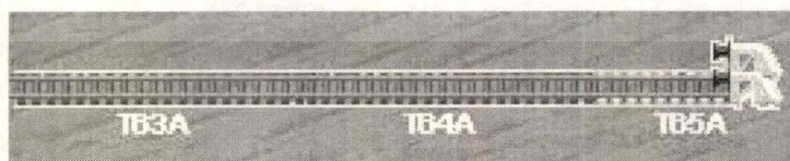
รูปที่ 4.23 แสดงสีขาวเมื่อ Track Circuits เป็นส่วนหนึ่งของ Route
