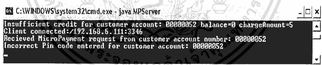
รูปที่ 5.44 แอปพลิเคชัน MPServer ฟิงเชิร์ฟเวอร์แสดงข้อผิดพลาดกรณีลูกค้ากรอกรหัสพินผิด
