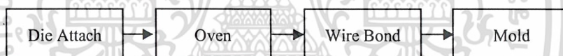
รูปที่ 3.6 ขั้นตอนการทำงานของกระบวนการผลิตรูปแบบที่ 2
