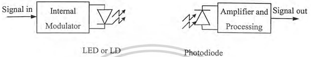
รูปที่ 4.29 การวัดคุณสมบัติการตอบสนองความถี่ของซิลิคอนโฟโตไดโอดแบบ p-i-n
