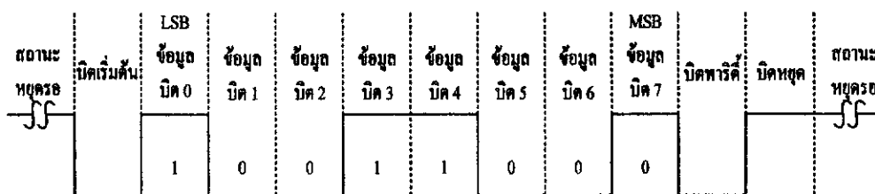
ภาพที่ 5.2 รูปแบบอย่างง่ายที่สุดของข้อมูลอนุกรมแบบอะซิงโครนัส
