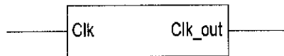
รูปที่ 4.2 สัญลักษณ์ของส่วนวงจรหารความถี่
