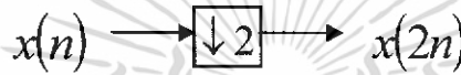
รูปที่ 2.5 ตัวสุ่มค่าตัวอย่าง (Down Sampler or Decimator)
