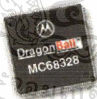
รูปที่ 2.3 แสดงรูปร่างของ MC68328 ของ Motorola ซึ่งเป็นชิปที่ใช้ในเครื่องปาล์ม
