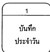
รูปที่ 2.1 แสดงสัญลักษณ์การประมวลผล (Process Symbol)
