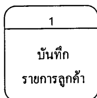
รูปที่ 2.1 แสดงสัญลักษณ์การประมวลผล (Process Symbol)
