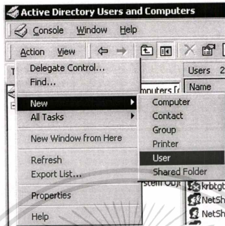
ภาพที่ 3.19 แสดงขั้นตอนการเรียกใช้เมนูเพื่อสร้าง User Account
