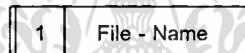
รูปที่ 2.4 แสดงสัญลักษณ์การเก็บข้อมูล (Data Storage)
