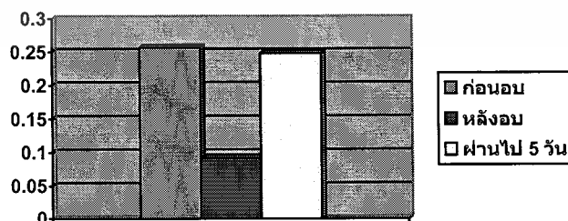
รูปที่ 4.22 การดูความชื้นของเม็ดพลาสติกพอลิเอทิลีนเทอเรฟทาเลท (PET)
