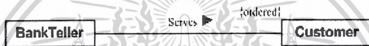
รูปที่ 2.7 แสดงความสัมพันธ์ระหว่างคลาสน์ในกรณีที่มีการระบุกฎ
