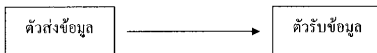
ภาพที่ 3.2 แสดงการส่งข้อมูลแบบทิศทางเดียว (Simplex)
