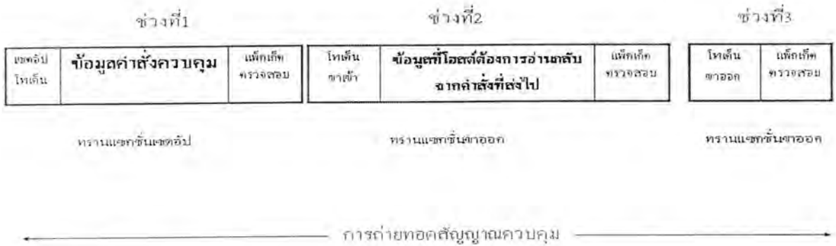
รูปที่ 2.14 แสดงรายละเอียดของแต่ละสแตจของการถ่ายทอคสัญญาณควบคุม
