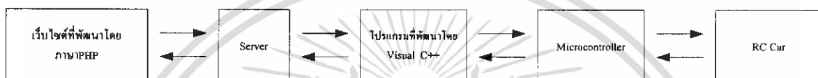
รูปที่ 3.1 บล็อกไดอะแกรมของระบบควบคุมรถตรวจการณ้ผ่านเครือข่ายคอมพิวเตอร์
