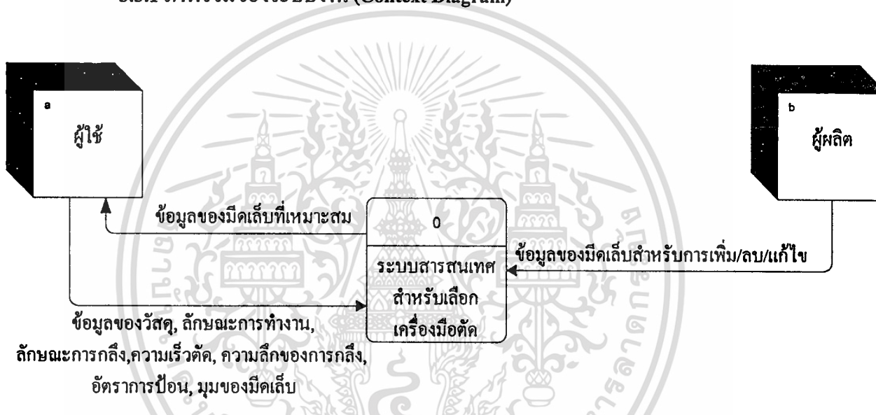
รูปที่ 3. 1 Context Data Flow Diagram Level 0 ของการเลือกมิดเกล็ด
