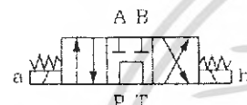
ทาลัว 4/2 ทำงานด้วยโซ่ลิ้นอยด์ทั้งสองด้าน สปริงดันกลับตำแหน่งกลาง A, B C และ P ต่อกับ 1
