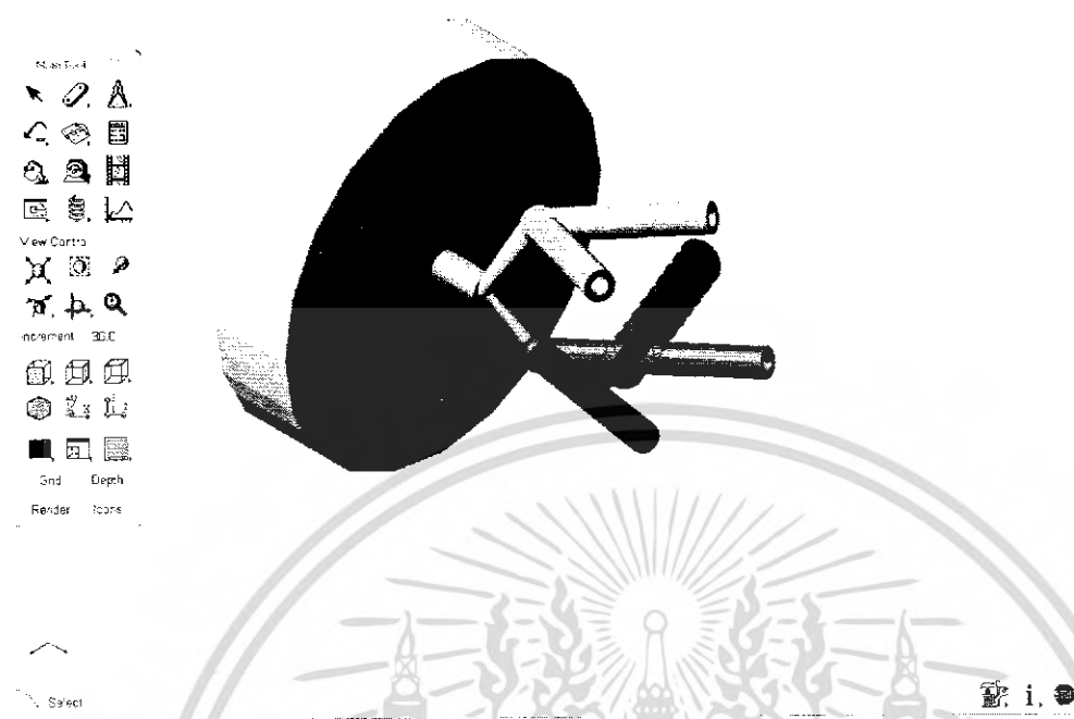
รูปที่ 5-23 ระบบช่วงล่างของรถ E-20 ด้านหน้า
