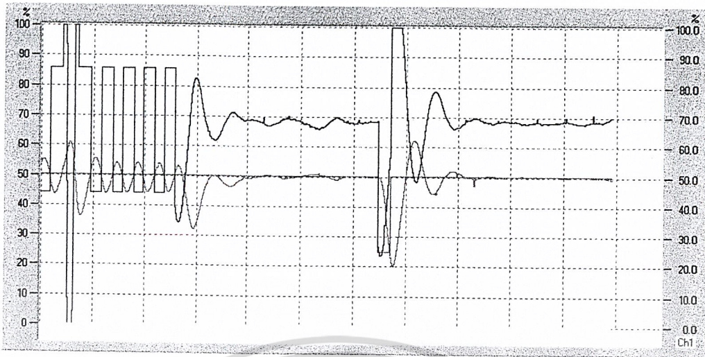
รูปที่ 5.9 แสดงผลตอบสนองของกระบวนการที่ค่าเป้าหมาย 50 % เมื่อตัวควบคุมเป็นแบบ PID และค่าพารามิเตอร์ที่ได้จาก Auto-Tuning K_p = 2.33, T_i = 12.5 \text{ sec}, T_d = 0.12 \text{ sec}, T_s = 84 \text{ sec}
