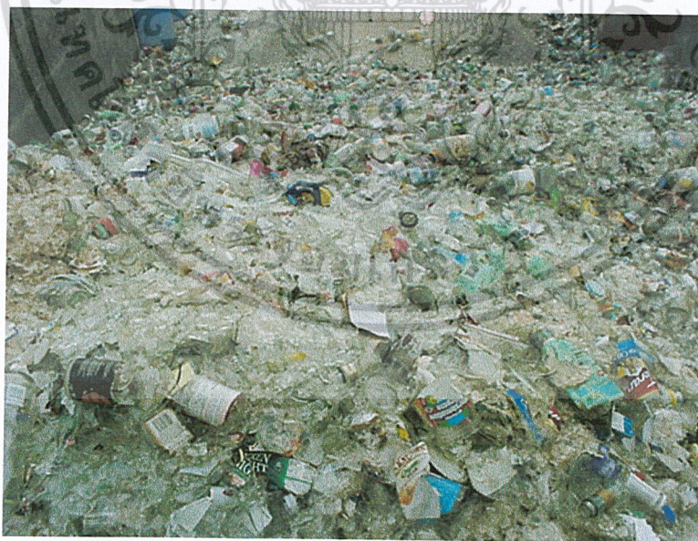
รูปที่ 1-1 แสดงรูปเศษแก้วที่เหลือใช้ก่อนจะนำมาบด
