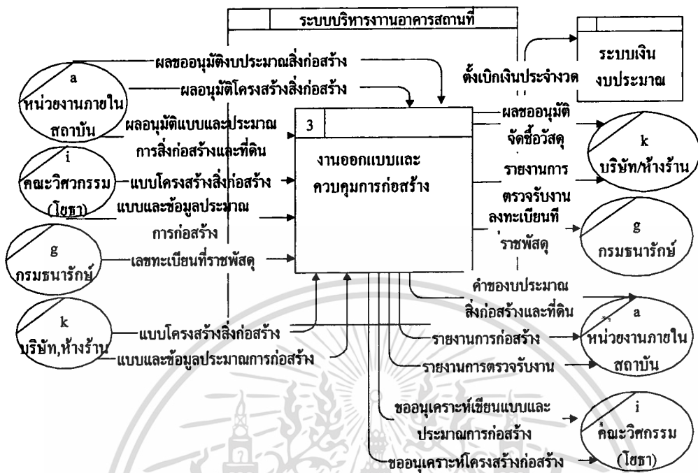
รูปที่ 5.3.1c แสดง DFD Level 1 แสดงงานออกแบบและควบคุมการก่อสร้าง
