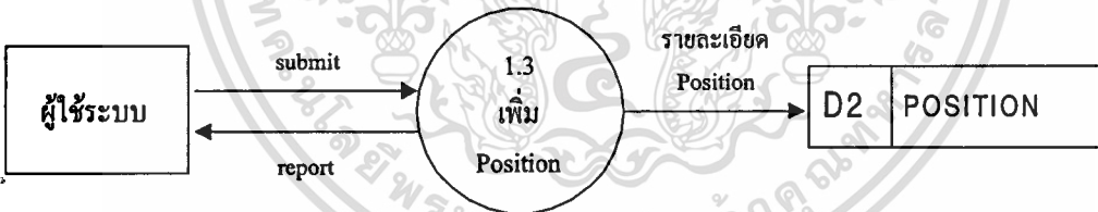
ภาพที่ 4.5 DFD แสดงรายละเอียดการเพิ่มตำแหน่งงานสำหรับผู้ใช้ระบบ
